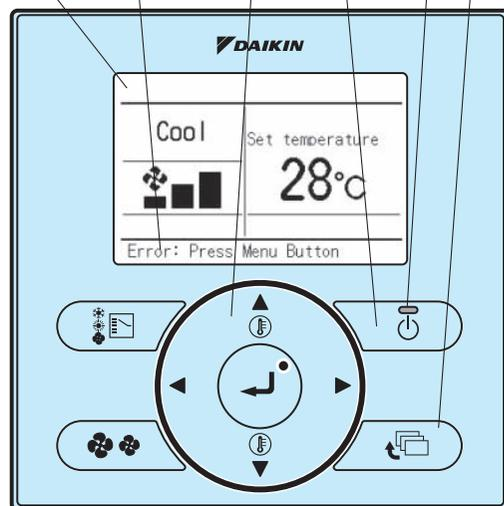
\* Lorsque le mode d'affichage des codes de dysfonctionnement est activé sur le côté gauche, l'enfoncement de la touche de marche/arrêt pendant quatre secondes ou plus provoque l'effacement de l'historique des dysfonctionnements.
