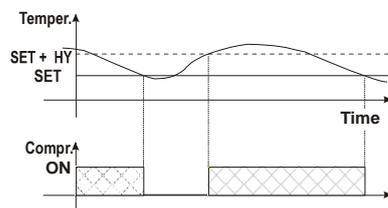
La régulation est obtenue par la température mesurée par la sonde d'ambiance avec un différentiel positif par rapport au point de consigne : lorsque la température augmente et atteint le point de consigne plus le différentiel, alors le compresseur démarre. Il s'arrête lorsque la température atteint de nouveau le point de consigne.
