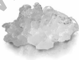
▲ Glace en grains Température 0/-1°C Humidité résiduelle 25 %
