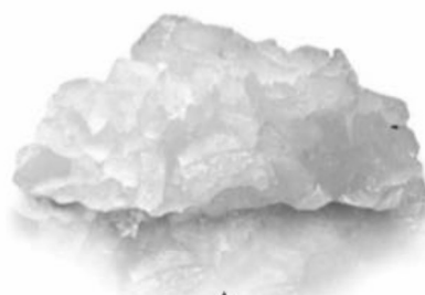
▲ Glace en supergrains Température -1/-2°C Humidité résiduelle 15 %
